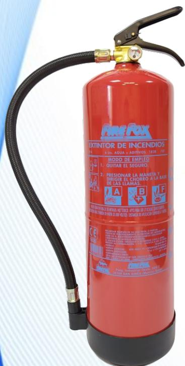
**BOTELLA:** De acero de alta calidad DC04 EN 10130:2006 conformada por embutición profunda, soldadura MIG , casquillo roscado soldado y, presilla soldada por puntos. Fondo con tetones. En el 100 % de botellas ha sido probada su estanqueidad y ausencia de fugas.
