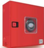
Armario metálico pintado para superficie o empotrar de **650 x 650 x 250 mm**. puerta con bisagras integradas y cerradura de resbalón de fácil apertura. Devanadera abatible de alimentación axial. Válvula de bola con manómetro. Lanza variomatic de triple efecto y 30 m. de manguera semirrigida 25 mm. EN-694.
