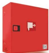
Armario metálico pintado para superficie o empotrar de **620 x 620 x 220 mm.** puerta encastrada ciega, bisagras integradas y cerradura de resbalón de fácil apertura. Devanadera abatible de alimentación axial. Válvula de bola con manómetro. Lanza variomatic de triple efecto y 20 m. de manguera semirígida 25 mm. EN-694. Posibilidad de 8 entradas de alimentación de agua. (Entradas laterales con válvula de asiento) Diámetro equivalente 10 mm./K:42
