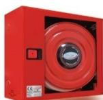
Armario metálico pintado para superficie o empotrar de **700 x 620 x 220 mm.** puerta encastrada para cristal bisagras integradas y cerradura de resbalón de fácil apertura. Devanadera abatible de alimentación axial. Válvula de bola con manómetro. Lanza variomatic de triple efecto. 20 m. de manguera semirígida 25 mm. EN-694. y toma adicional de 45 mm. con válvula asiento, racor y tapón UNE-23400. Cristal o metacrilato no incluido.
