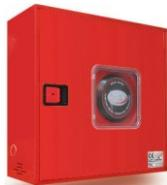
Armario metálico pintado para superficie o empotrar de **620 x 620 x 220 mm.** puerta encastrada con visor, bisagras integradas y cerradura de resbalón de fácil apertura. Devanadera abatible de alimentación axial. Válvula de bola con manómetro. Lanza variomatic de triple efecto y 20 m. de manguera semirígida 25 mm. EN-694. Metacrilato incluido. Posibilidad de 8 entradas de alimentación de agua. (Entradas laterales con válvula de asiento) Diámetro equivalente 10 mm./K:42
