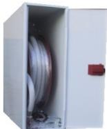
Armario para superficie o empotrar con puerta ciega, formado por Bie WORKFIRE-25, devanadera fija de alimentación axial, válvula de bola con manómetro, lanza variomatic de triple efecto y 20 m de manguera semirrigida 25 mm EN-694. Medidas: 750 x 250 x 680 mm.
