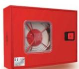
Compuesta por armario para superficie o empotrar de **450 x 600 x 130 mm**. puerta con visor, bisagras integradas y cerradura de resbalón de fácil apertura. Devanadera de radios. Válvula de asiento con manómetro. Lanza variomatic de triple efecto. racores barcelona según UNE-23400 "Uso Ligero" y 15 ó 20 m. de manguera plana de 45 mm.
