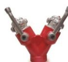
Bifurcación 70 mm. Aluminio con válvulas. Entrada rosca interior 3" x 2 Salidas rosca exterior de 2 1/2". Racores tipo barcelona aluminio UNE-23400.
