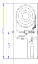
Compuesto por armario metálico pintado de **1250 x 620 x 250 mm**. con puerta encastrada ciega y cierre de resbalón, devanadera abatible de alimentación axial, válvula con manómetro, lanza de espuma de baja expansión 100 l./min., 20 m de manguera semirrigida 25 mm EN-694. con sistema de generación de espuma, incluyendo bidón de espumógeno de 20 l. (AFFF 3%) y proporcionador de porcentaje variable con opción bypass (agua) - espuma.
