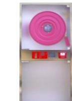
Armario para superficie o empotrar con puertas de metacrilato incoloro hielo, formado por Bie WORKFIRE-25 ASA, Módulo Técnico (personalizable) para incorporar la luminaria de emergencia, el pulsador y sirena de alarma y Módulo Extinción para 2 extintores. Medidas: 1450 x 650 x 250 mm. Luminaria, detección y extintor no incluidos.
