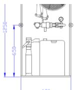
Recubrimiento, devanadera de radios, válvula de asiento con manómetro, taza de espuma de baja expansión 200 l./min., racores barcelona UNE-23400 "USO LIGERO" y 20 m de manguera sintética plana de 45 mm. Equipado con sistema de generación de espuma, incluyendo bidón de espumógeno de 20 l. (AFFF 3%) y proporcionador de porcentaje variable con opción by-pass (agua) - espuma.
