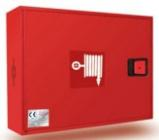
Compuesta por armario para superficie o empotrar de **450 x 600 x 130 mm**. puerta ciega, bisagras integradas y cerradura de resbalón de fácil apertura. Devanadera de radios. Válvula de asiento con manómetro. Lanza variomatic de triple efecto. racores barcelona según UNE-23400 "Uso Ligero" y 15 ó 20 m. de manguera plana de 45 mm.
