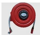
Devanadera de alimentación axial. Válvula de bola con manómetro. Lanza variomatic de triple efecto y 20 m. de manguera semirígida 25 mm. EN-694.
