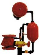
Puestos de control RANURA-RANURA para tubería húmeda. Compuestos por Válvula de alarma, motor de agua, campana de alarma, cámara de retardo y accesorios del trim montados (manómetros, manguitos y accesorios de conexión).
